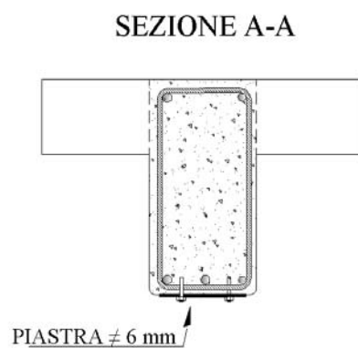
Figura 84. Vista in sezione di cui alla Figura 83
