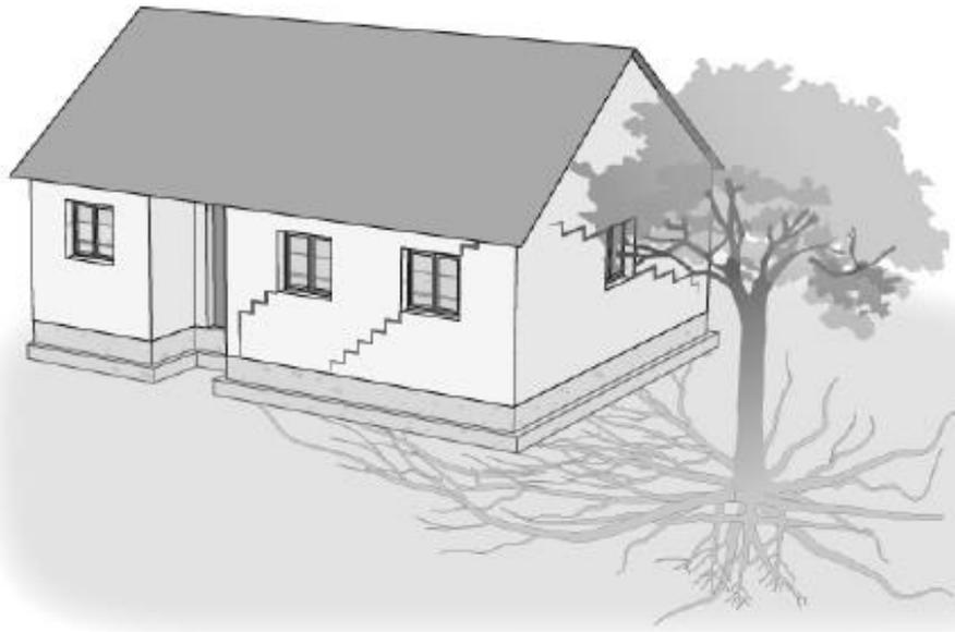
Figure 1. Fissures en escalier de tassement par succion dans un angle
