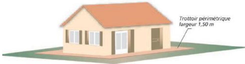
Sistema impermeabile che circonda l'edificio
