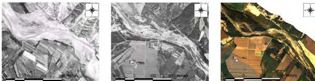
Fig. 2 - Il fiume Paglia, in un tratto della sua bassa valle, in tre riprese aerofotogrammetriche (1954, 1977, 1999). È evidente l'evoluzione del tracciato fluviale che da una tipologia francamente braided (1955) si è progressivamente evoluto in un alveo "wandering" (divagante), tendente al monocanale inciso.
