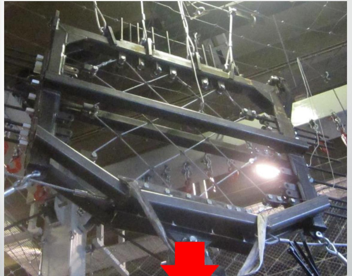
**Obiettivo della prova a trazione:** Valutare per ogni pannello la resistenza a trazione longitudinale, trasversale, e la deformazione longitudinale associata
